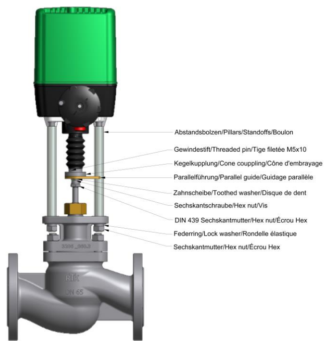
Aufbau auf Armatur - Säulen/Mounting on a valve – pillars
