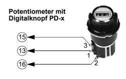
Um den Sollwert mit einem Potentiometer vorgeben zu können, stellt der Regler an Klemme 15 eine Referenzspannung von +10 VDC (±5%) zur Verfügung.
