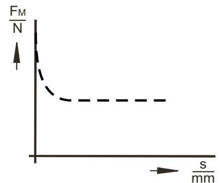
Bild 2: Magnetkraft-Hub-Kennlinie im Bereich des Nennhubes
