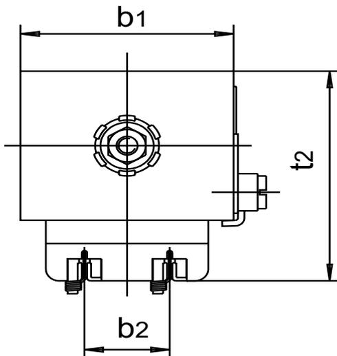
Oberfläche: Mantel und Kern verzinkt, Anker vernickelt
