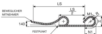
Bei einer gleitenden Anwendung können diese Werte je nach Beanspruchung variieren (Verfahrfähigkeit, Belegungsgewicht, Klima)
